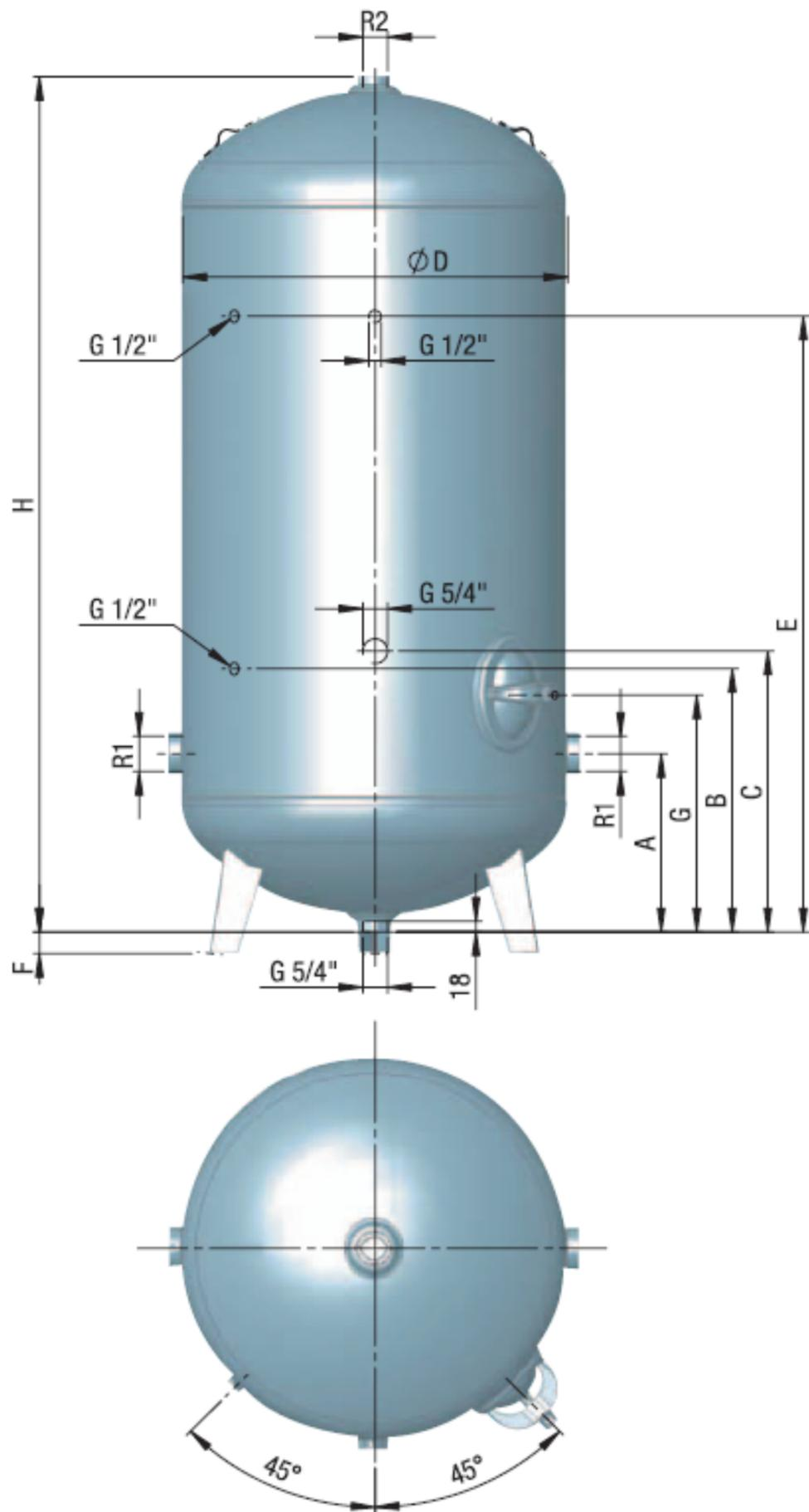
Die Windkessel der Typenreihe WK sind aus Qualitätsstahl nach EN-Normen hergestellt und eignen sich hervorragend zum Einsatz in Trink- und Betriebswassernetzen. Besonders zur Dämpfung von Druckstößen in Netzen, beziehungsweise zur Aufrechterhaltung eines konstanten Leitungsdruckes, sind die Behälter mit einem Inhalt von 150 bis 500 Liter bestens geeignet.
